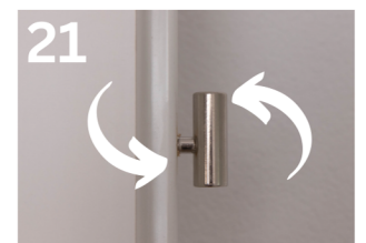
21 Kontrollieren Sie jetzt die einwandfreie Funktion der Tür und stellen Sie diese ggf durch ein- und ausdrehen der Bänder oder der Bandunterteile in der Zarge nach
