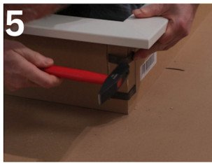
5 Schlagen Sie die Klammern in die dafür vorgesehenen Nuten in der Futterplatte ein
